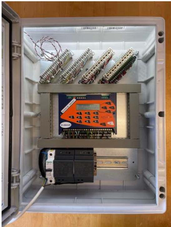
KESKUSLAITE 10878900 "MAX CEN12", JOHON ON LISÄTTY KAHDEN OVEN LAAJENNUS 10879090. Kahden oven laajennuskortti 10879060 sijoitetaan CEN12 keskuslaitteen alle, ja keskukseen lisätään kaksi LSA-liittintä.
