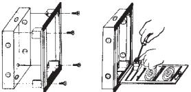
Il Telaio viene montato nelle scatole tramite delle viti che raggiungono le loro sedi apposite, anche nel caso che la scatola sia stata murata troppo in profondità.
